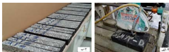
شکل ۳. الف) برش دال توسط اهر برقی ب) نمونه های تیرچه
