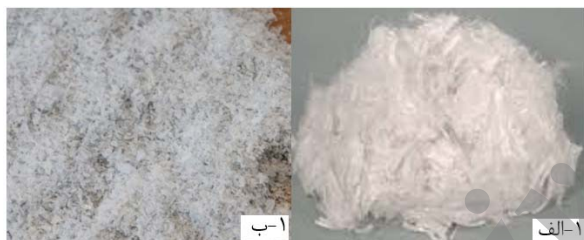
شکل ۱. الف) الیاف پلیاستیکی (PET ب) خرده پلیاستیک PET
