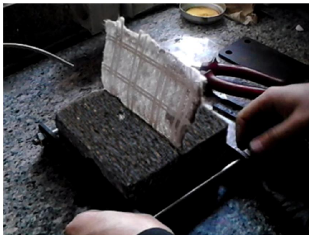
شکل ۳. نحوه ساخت نمونه‌های آزمایش بیرون کشش
