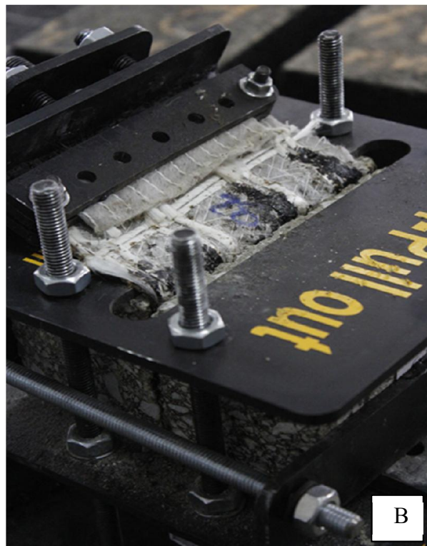
شکل ۴: دستگاه انجام آزمایش Pullout به صورت متصل (A) و جدا (B) از دستگاه UTM
