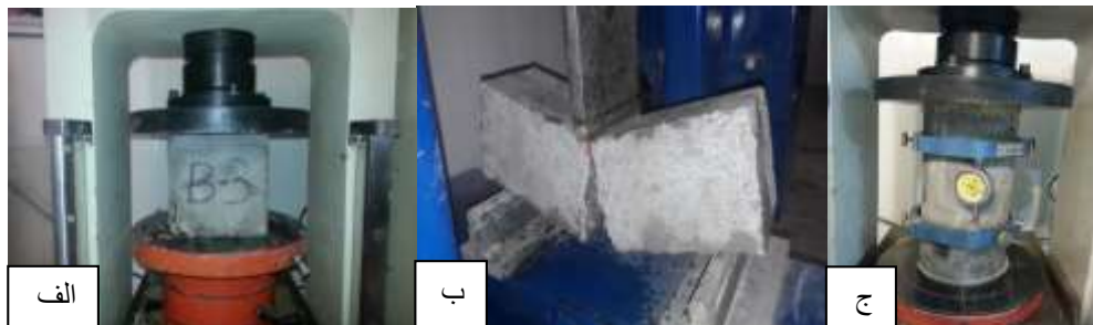
شکل ۶. نمونه های تحت آزمایش (الف) آزمایش مقاومت فشاری (ب) مقاومت خمشی (ج) مدول الاستیسیته
