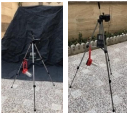
شکل ۹. سخت افزار برداشت تصاویر خرابی روسازی آسفالتی در شرایط کنترل شده.
