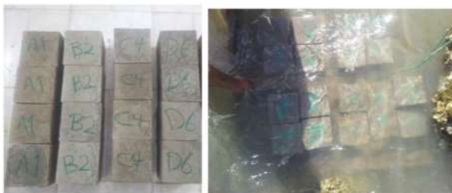
شکل ۱. آماده سازی نمونه ها در آزمایشگاه و انتقال به محیط جزر و مدی خلیج چابهار
