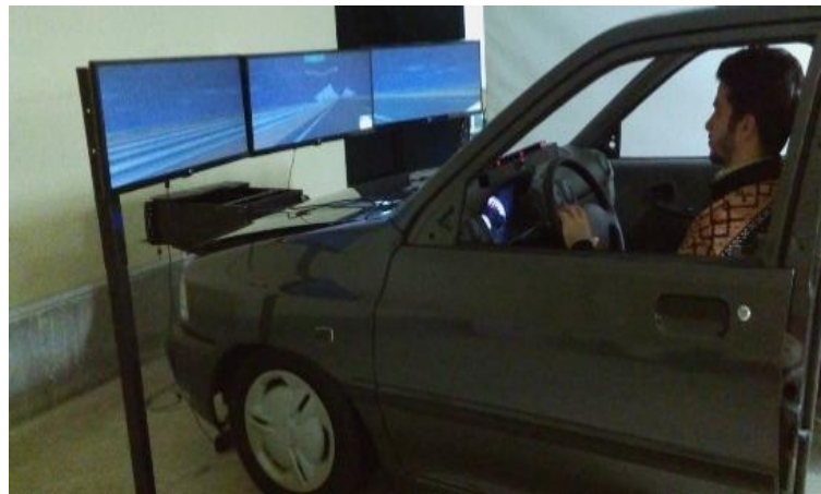
شکل ۲. نمایی از دستگاه شبیه‌ساز رانندگی و یک آزمون دهنده در حال رانندگی
