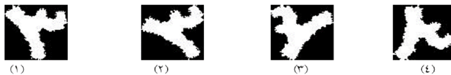
شکل ۱۳. استخراج ویژگی با استفاده از ممان‌های زرنیک تا مرتبه ۶ و تعداد تکرار مثبت تا تعداد ۶ که در کل ۱۶ ویژگی است.
