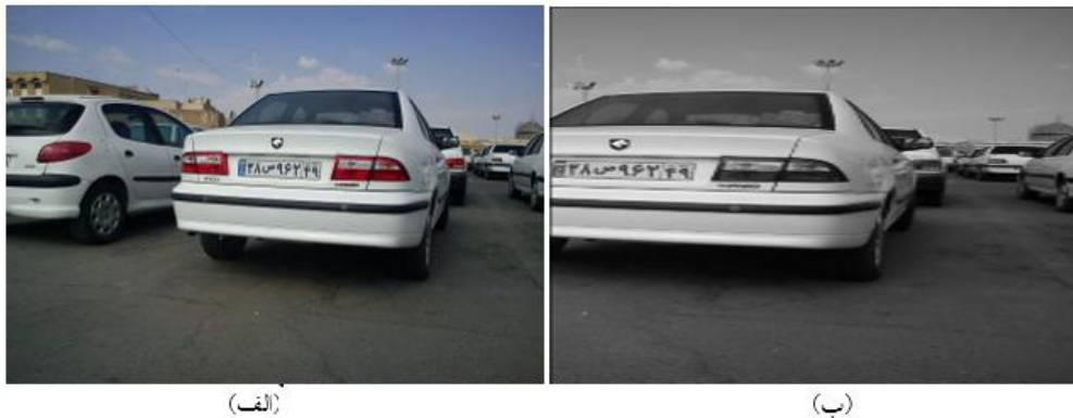
شکل ۶. شناساگر ناحیه آبی پلاک الف) تصویر خودروی ورودی ب) استفاده از شناساگر ناحیه آبی جهت محل یابی راحت‌تر و سریع‌تر پلاک خودرو
