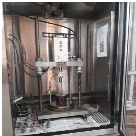
شکل ۴. نمایی از دستگاه UTM قبل از آزمایش خزش دینامیکی
