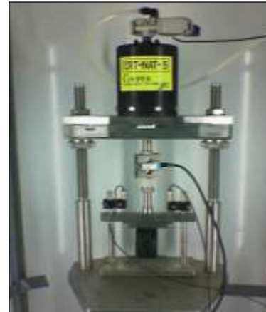
شکل ۴. نحوه بارگذاری نمونه‌ها در آزمایش خستگی
