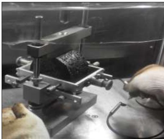
شکل ۷. نحوه قراردادن نمونه در آزمایش مدول برجهندگی
