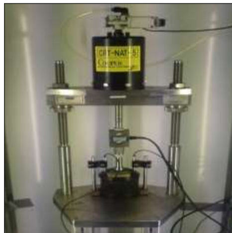
شکل ۶. نحوه بارگذاری در آزمایش خزش دینامیکی
