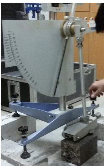
شکل ۸. نحوه انجام آزمایش آونگ انگلیسی
