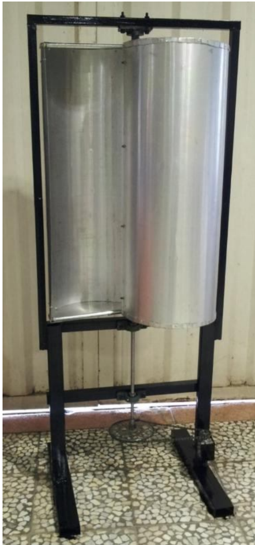
شکل (11): نمونه توربین بادی ساخته شده
