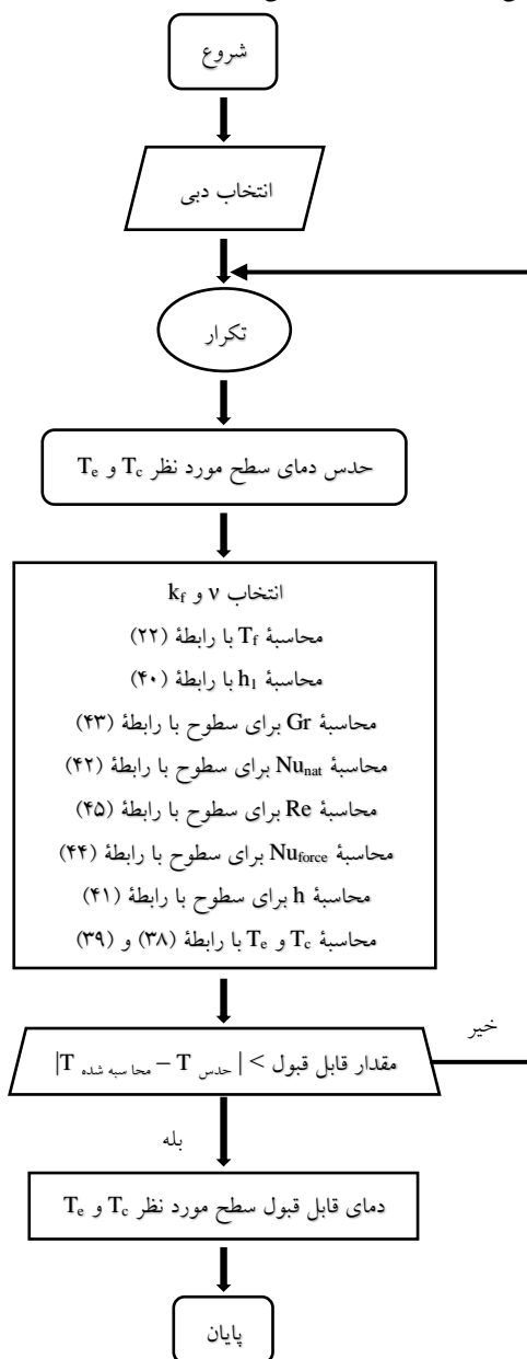
شکل (۳): فلوچارت حل معادلات برای محاسبه دمای سطوح زمین زیر کلکتور و سقف کلکتور
