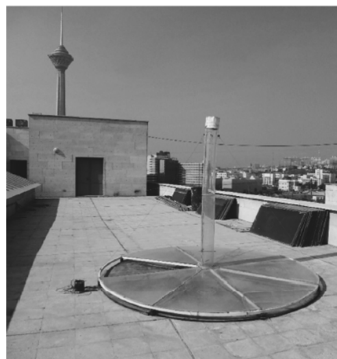
شکل (۲): مدل دودکش خورشیدی ساخته شده در دانشگاه تهران [۱۶]
