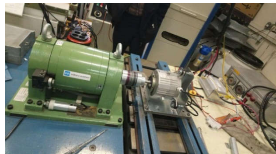
شکل (۸): دینامومتر نوع هیستریزیس مورد استفاده برای تعیین بازده موتور براشلس
