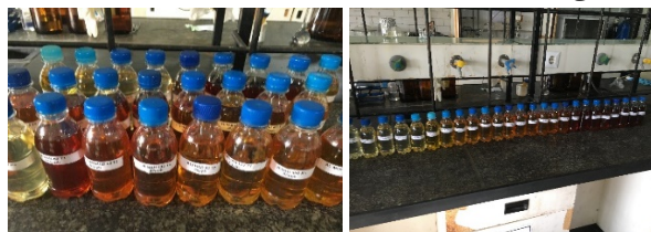
شکل (۵): نمونه روغن‌های اخذشده جهت طیف‌نگاری نوری
