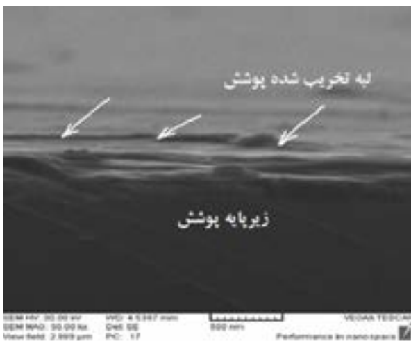
شکل ۱۱- تصویر SEM مقطع عرضی نمونه پوشش L2B2.
