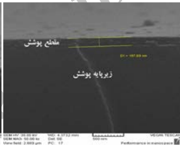
شکل ۱۰- تصویر SEM مقطع عرضی نمونه پوشش L3B3.
