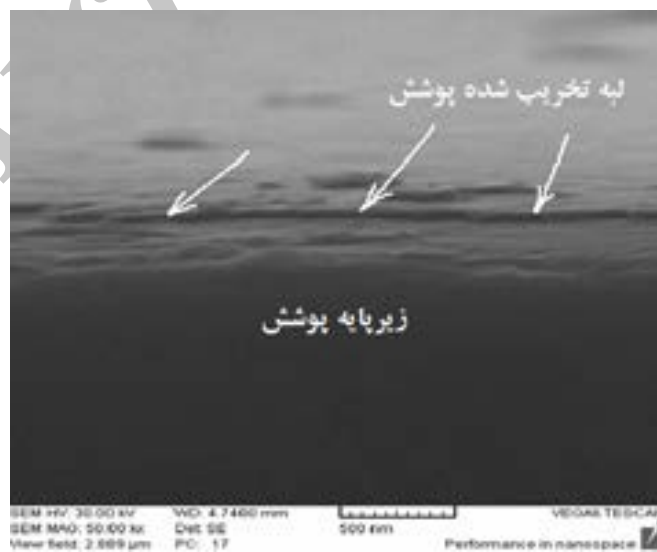
شکل ۱۲- تصویر SEM مقطع عرضی نمونه پوشش L1B1.
