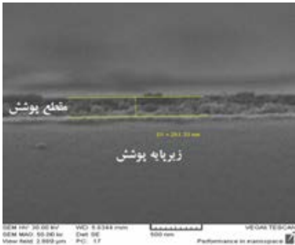
شکل ۹- تصویر SEM مقطع عرضی نمونه پوشش L4B4.
