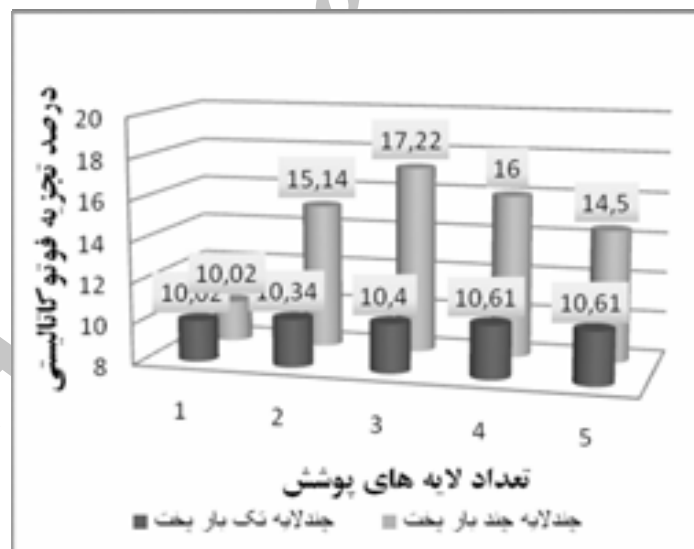
شکل ۱۶- مقایسه درصد تجزیه فوتوکاتالیستی نمونه های پوشش چندلایه چند بار پخت و تک بار پخت تحت تابش UV.
