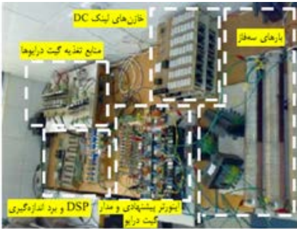
شکل ۱۴: نمونه آزمایشگاهی سیستم پیشنهادی.
