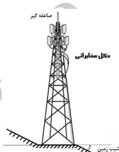
شکل ۱۰: اثر ارتفاع دکل مخابراتی بر احتمال برخورد صاعقه به آنتن.
