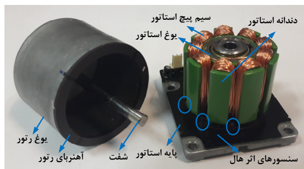
شکل ۷: موتور آهن ربای دایم ساخته شده.
