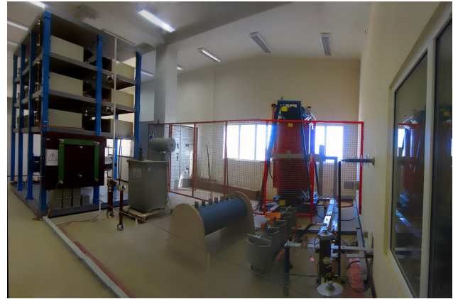
شکل ۱۳: نمایی از مدار آزمایشگاه سینتتیک طراحی و ساخته شده، سمت راست ترانسفورماتور و راکتورهای محدودکننده جریان و سمت چپ مدار ولتاژ.
