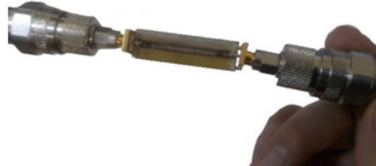
شکل ۷: تصویری از لحیم‌کاری اتصال دهنده هم‌محور به پشت و روی زیرلایه راجرز.
