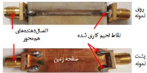
شکل ۷: تصویری از لحیم‌کاری اتصال دهنده هم‌محور به پشت و روی زیرلایه راجرز.
