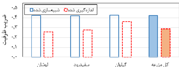
شکل ۱۲: ضرایب ظرفیت سالانه باس‌بارهایی که فیدرهای مزرعه به آنها متصل هستند در کل ساعات (CF_{Y,D}^{F_{s,A}}) .
