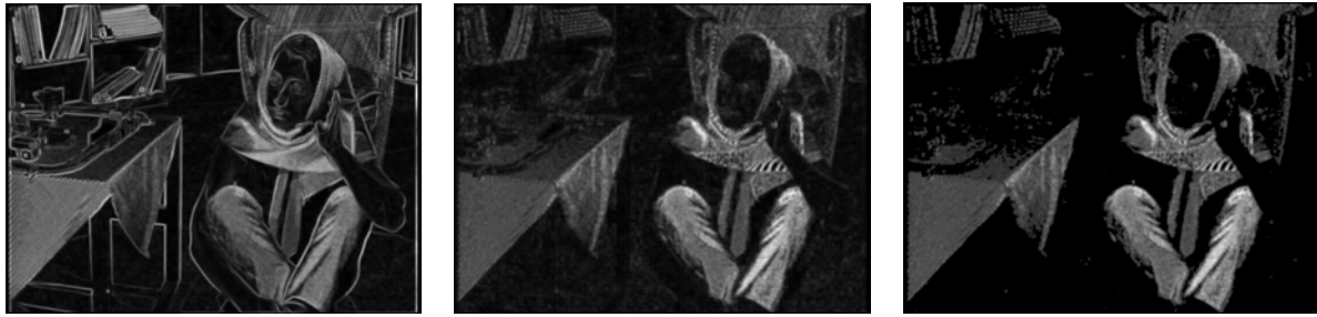
شکل ۵: واریانس محلی شکل ۳-الف در همسایگی 5 \times 5 ، (الف) نتیجه واریانس محلی روی تصویر اصلی، (ب) نتیجه واریانس محلی روی تصویر بافت به دست آمده از ROF و (ج) نتیجه آستانه‌گذاری روی تصویر (ب).
