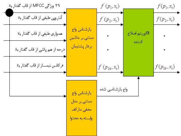
شکل ۴: به کارگیری اطلاعات وابسته به محتوا در جهت اصلاح نتایج بازناسی واج مبتنی بر ماشین بردار پشتیبان.
