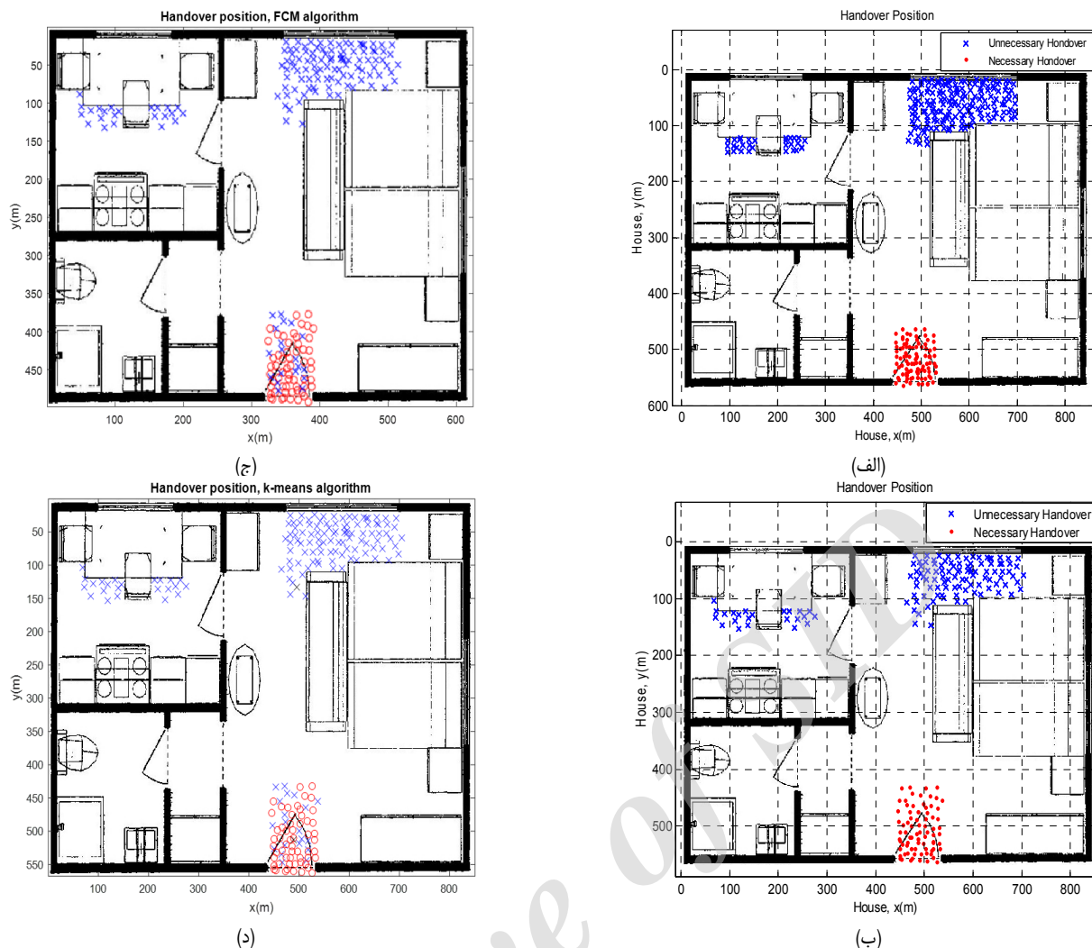
شکل ۲۰: مقایسه عملکرد چهار روش (الف) k-means، (ب) FCM، (ج) SC و (د) GSC در تفکیک HOهای مجاز از غیر مجاز برای سناریوی اول.
