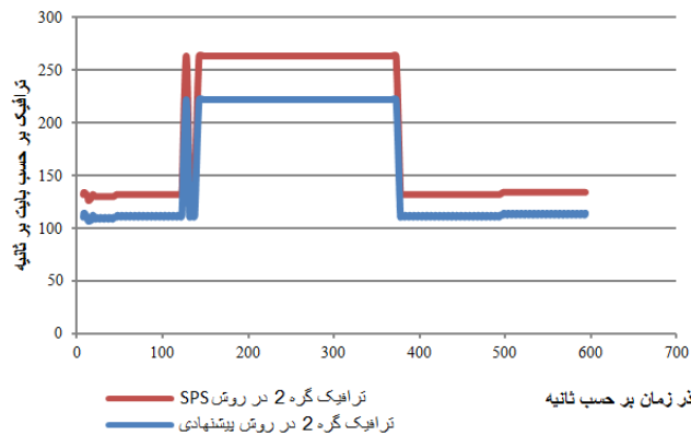
شکل ۱۲: تفاوت روش پیشنهادی و روش SPS در ترافیک خروجی گره شماره ۲ (در ۶۰۰ ثانیه).
