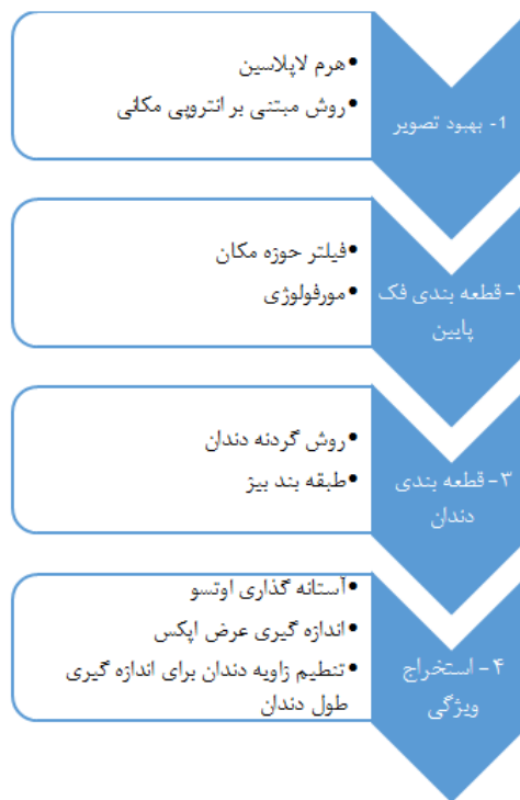
شکل ۳: بلوک دیاگرام مراحل پردازش تصویر.
