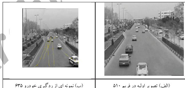
شکل ۵) نمونه ای از بکارگیری فیلتر کالمن در ردگیری خودرو با استفاده از ویژگی خط تقارن
