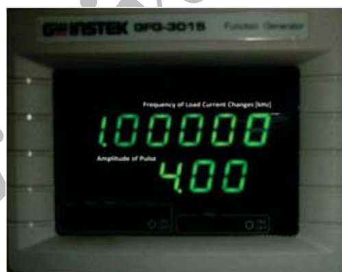
شکل ۱۴. دامنه و فرکانس تغییرات بار خروجی در تست های آزمایشگاهی
