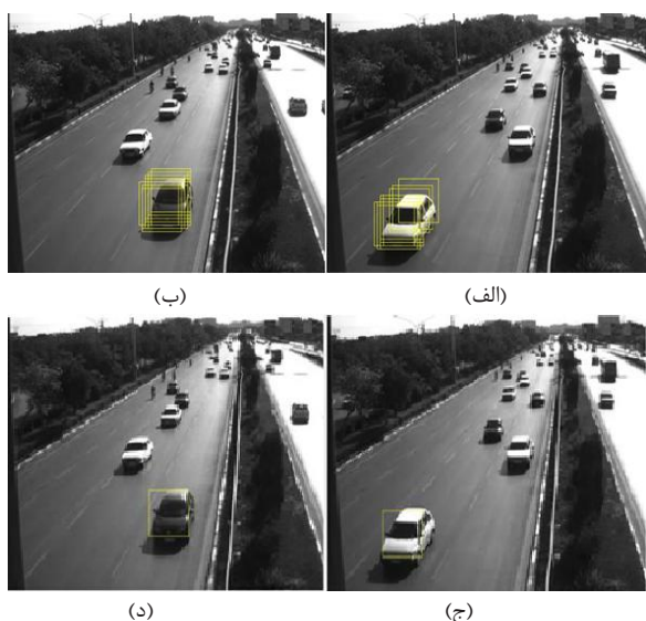
شکل ۱۲. (الف) و (ب) شناسایی اولیه دو خودرو با آستانه ۰/۱۴، (ج) و (د) نتیجه ادغام پنجره‌ها.
