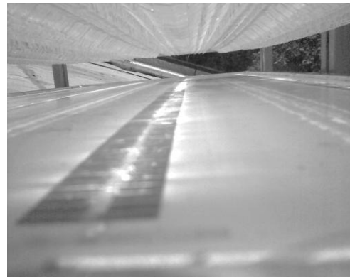
شکل ۱۱. نحوه قرار گرفتن عدسی در مقابل پنل و تمرکز نور روی پنل
