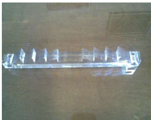
شکل ۶. نمونه ساخته شده لنز فرنل
