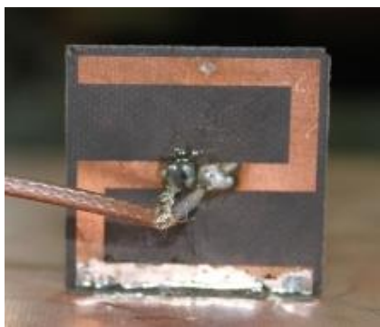
شکل ۳. نحوه اتصال کابل کوکسیال به آنتن به منظور پیاده سازی پورت تطبیق شده روی آن
