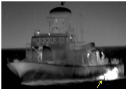
شکل ۱۲. آگزوز و خروجی آب در نمای مایل هدف در تصویر IR در شب با فاصله‌ی تقریبی ۳۵۰ متر
