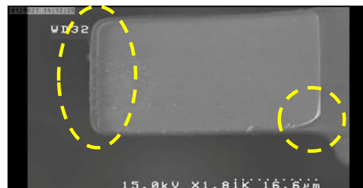
شکل ۸ تصویر روبشی تیرک ساخته شده به طول ۵۰µm و عرض ۲۰µm که Al بر روی SiO 2 قرار گرفته است.
