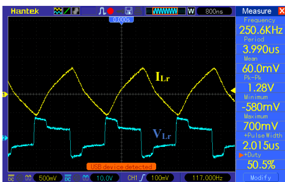
شکل ۲۱. شکل موج های ولتاژ و جریان سلف L_r
