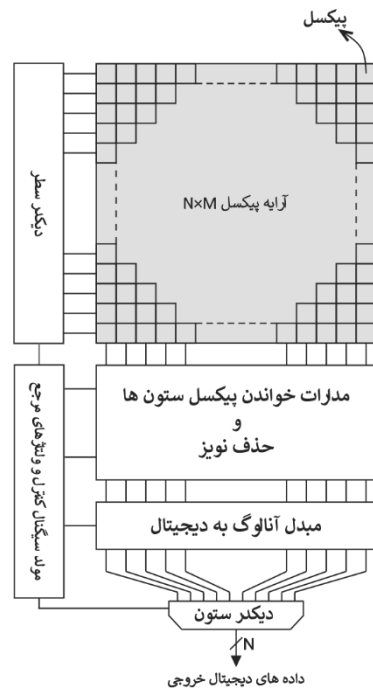
شکل ۱. بلوک دیاگرام سنسور تصویر با معماری رایج ستون-موازی
