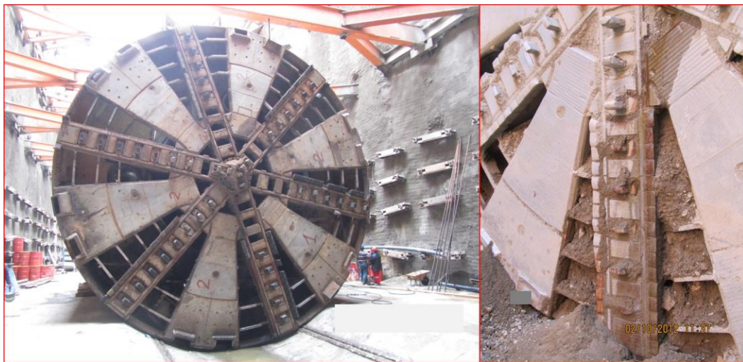
شکل ۹- چپ) ابزارهای برشی خرده شده قبل از تعویض و راست) ابزارهای برشی تعویض شده بر روی کله‌حفار
