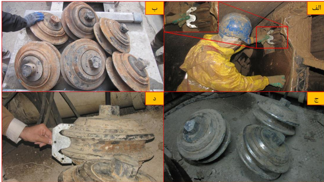
شکل ۸- الف) اندازه‌گیری میزان سایش قبل از تعویض، ب) دیسک‌های نو، ج) دیسک‌های ساییده شده و د) اندازه‌گیری دیسک‌های ساییده شده بعد از تعویض
