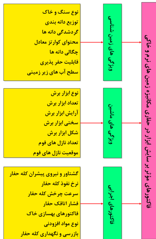
شکل ۱- عوامل مؤثر بر سایش ابزار برش در تونلسازی مکانیزه با ماشین‌های EPB
