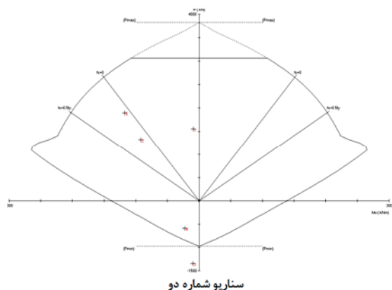
شکل ۱۲- ظرفیت مقطع پوشش نهایی و نیروهای القا شده به آن
