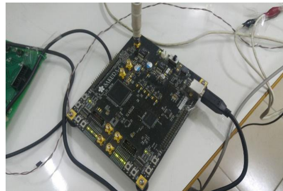
شکل (۱۲): تصویر برد استاندارد حملات کانال جانبی موسوم به برد ساکورا حاوی تراشه Spartan-6 XC6SLX75 که در آزمایش‌های مورد استفاده قرار گرفت.
