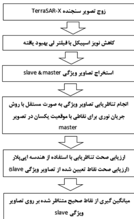
شکل ۱. مراحل انجام راه‌کار پیشنهادی جهت بهبود تناظریابی تصاویر ماهواره‌ای TerraSAR-X به کمک ویژگی‌های بافت تصویری
