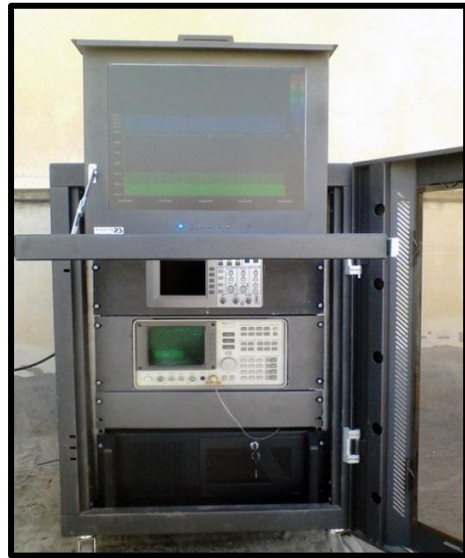
شکل ۱۰. رک مربوط به گیرنده ساخته شده
