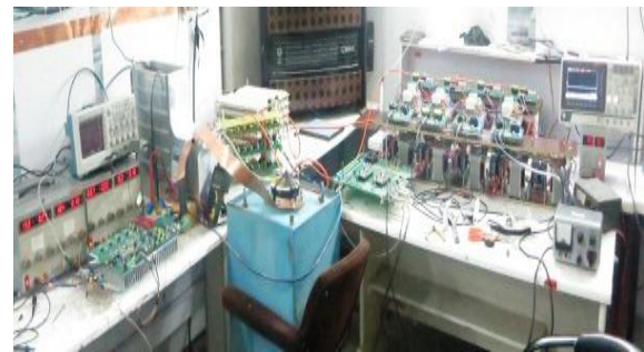
شکل (۲۸): تغذیه کاتد شامل اینورتر ۲۰KV و پس رگولاتور ۱۰۰۰ V و سوئیچ کلید زنی ولتاژ بالا و بار اهمی
