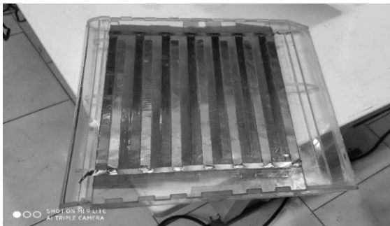
ب) صفحه تخت مورد استفاده با عملگرهای پلاسمای نصب شده
