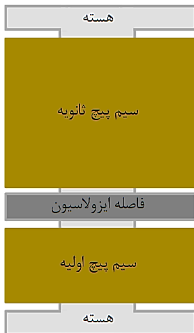
شکل (۷): نحوه قرارگیری سیم‌پیچ‌ها بر روی هسته ترانسفورماتور.
