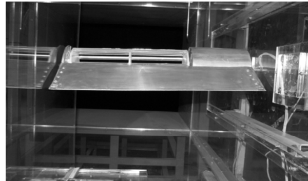
شکل (۶): بال حاوی فن در تونل باد و متصل شده به دستگاه اندازه‌گیری نیروهای آیرودینامیکی.
