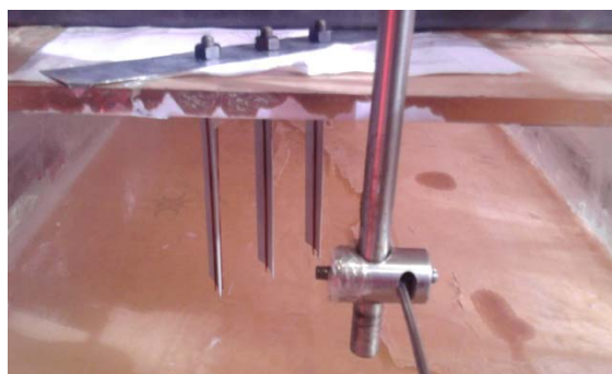
شکل (۳): نمایی از نصب سیم‌های اغتشاش ساز بر روی پره‌های کمپرسور در تونل باد.
