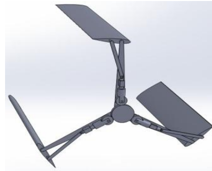
شکل (۲۰): طرحی از توربین بادی داریوس مجهز به مکانیزم گام متغیر.
