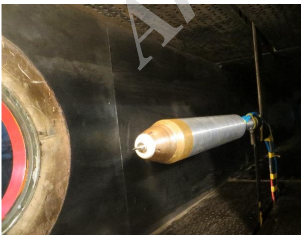
شکل (۵): مدل مخروطی با دماغه مخروطی ناقص 60^\circ و اسپایک آبرو پلاسمایی نصب‌شده در محفظه آزمون تونل باد مافوق صوت.
