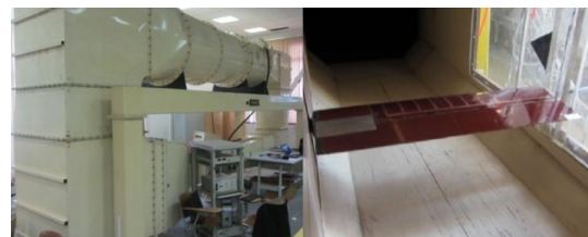
شکل (۴): تونل باد مدار بسته مادون صوت TE-44/c و مدل ایرفویل.
