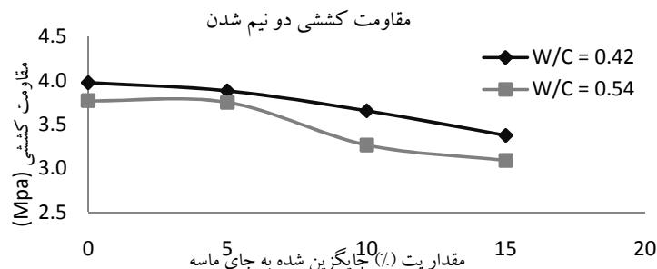
شکل ۴- مقاومت کششی نمونه ها در مقادیر مختلف PET در نسبت های آب به سیمان متفاوت
