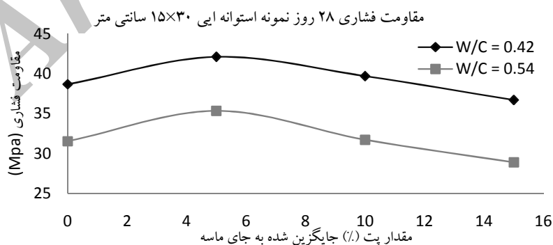
شکل ۳ - مقاومت فشاری ۲۸ روز نمونه استوانه‌ای ۱۵×۳۰ سانتی متر
